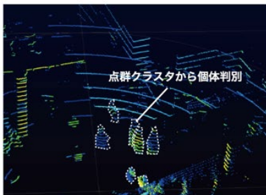
三次元レーザ計測による歩行者挙動同定
