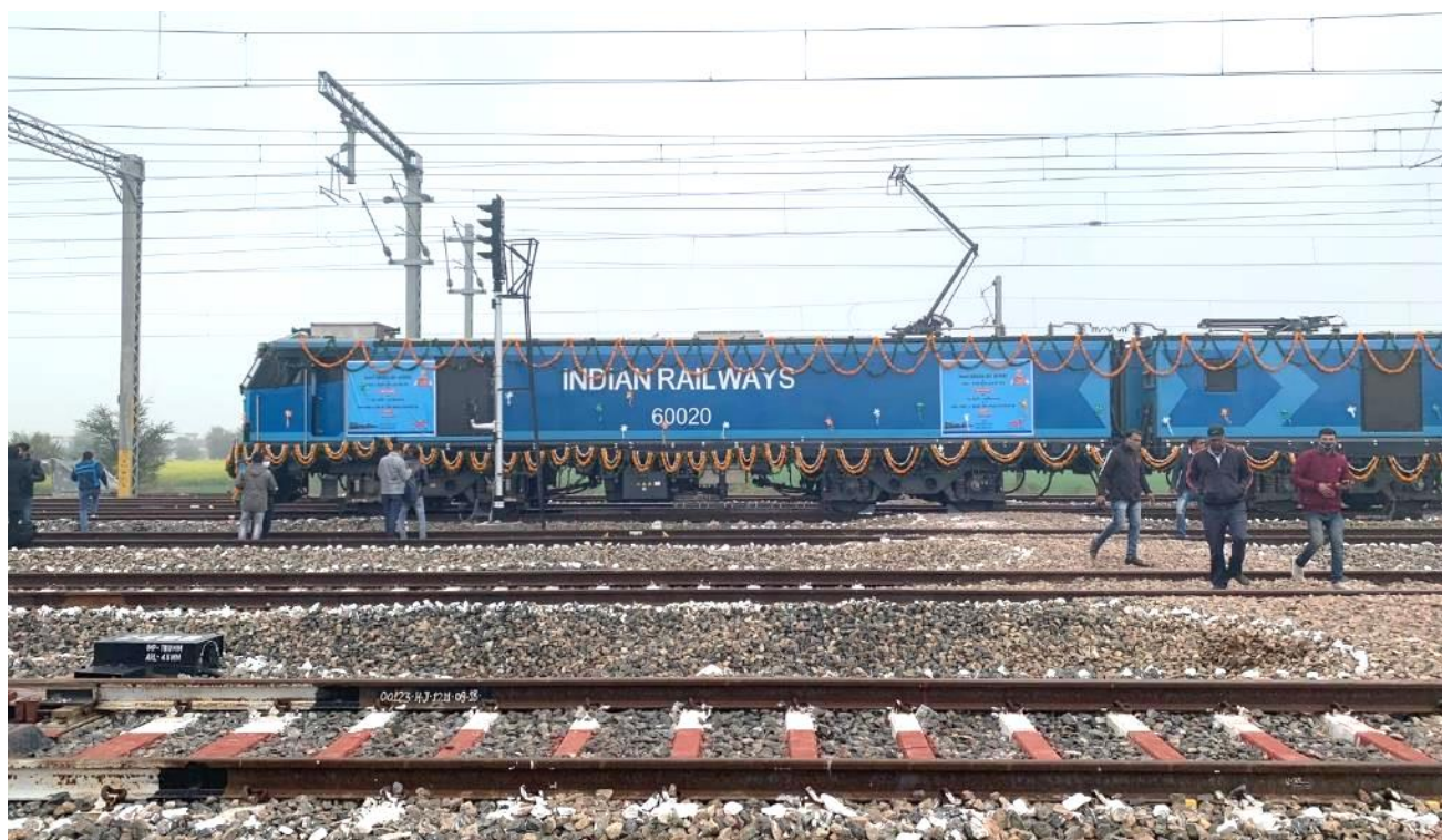
インド国鉄が開発した 12,000 馬力の電気機関車は高揚程パンタグラフを装備している。
