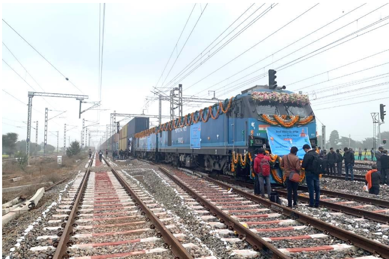
DFC コンテナ貨物列車。後方に 2 段積海上コンテナ貨車 45 両（海上コンテナ 90 箱）を接続。
