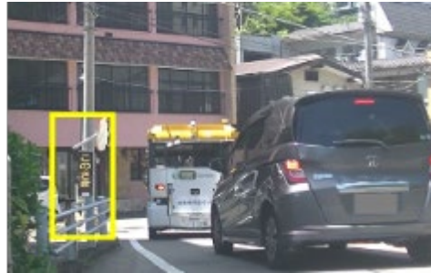
■ カーブ手前において、自動運転バスが近づくことを一般車両に知らせる「ICT LED 電光掲示板」（栃木県那須塩原市実績）
