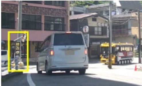
■ カーブ手前において、自動運転バスが近づくことを一般車両に知らせる「ICT LED 電光掲示板」（栃木県那須塩原市実績）
