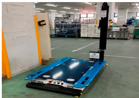
大阪オペレーションセンターに導入されたAMR(自律式無人搬送ロボット)
