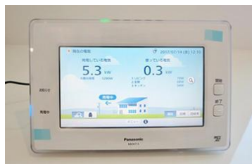
分譲戸建てに採用した エネルギー計測器
