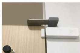
混雑状況の検知は、 トイレのドアなどに センサーを設置する
