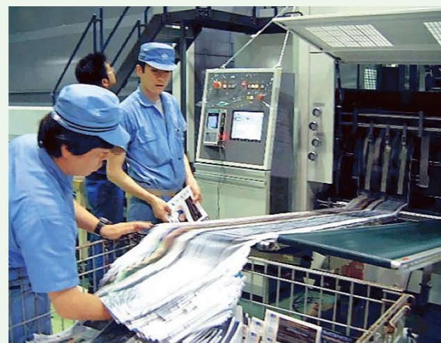
印刷開始時、印刷品質が安定するまでに発生する「刷り出し損紙」の量を、1/5に削減した小森の印刷機。(写真:小森コーポレーション様ご提供)
