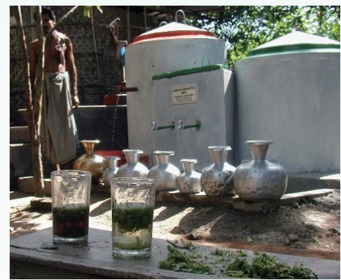
手前の台には、グアバの葉を刻んだものとガラス容器が2本置かれています。この地域のヒ素が含まれた井戸水（左の容器）にグアバの葉を入れると水が真っ黒にごりますが、ヒ素をろ過した水（右の容器）にグアバの葉を入れても透明のまま変化しません。地元の資源を活用した簡易調査方法です。後方は、ハンガー・フリー・ワールドによって作られた井戸水のヒ素ろ過装置。（写真提供=ハンガー・フリー・ワールド）
