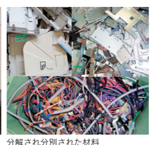
分解され分別された材料 プリント基板、ハーネス（電源コード）、プラスチック、鉄、モーター類などに分解分別し、それぞれの材料処理業者に引き渡しています。
