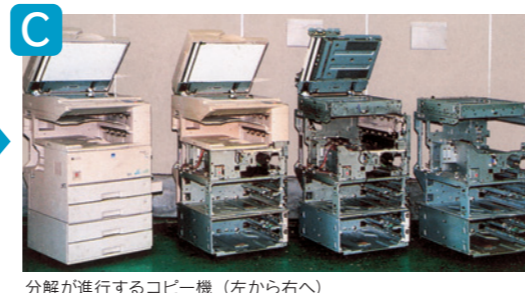
分解が進行するコピー機 (左から右へ) 回収センターのひとつがある三愛ロジスティクス株式会社東北グリーンセンター（宮城県）では、回収されたリコー複写機のうち、材料としてリサイクルする機械の分解・分別をしています。
