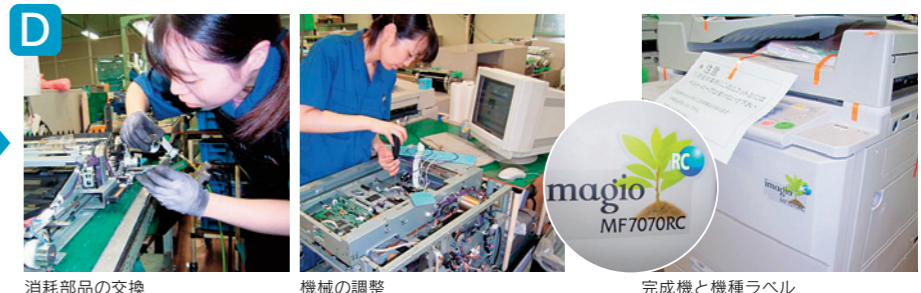
消耗部品の交換 機械の調整 完成機と機種ラベル 隣接する東北リコー株式会社では、2通りの方法でリサイクルを行っています。一つは市場回収機から部品を抜き取り、新品機に搭載する「部品再利用」。もう一つは回収機のローラーやゴム製の部分など消耗部品を新しくしたり、各機能の調整をしたりして「RC機（リコンディショニング機）」として市場に提供することです。完成したRC複写機(imagio7070RC)は、部品の質量比87%以上が再生部品で、外装カバーは原則100%が再利用されています。
