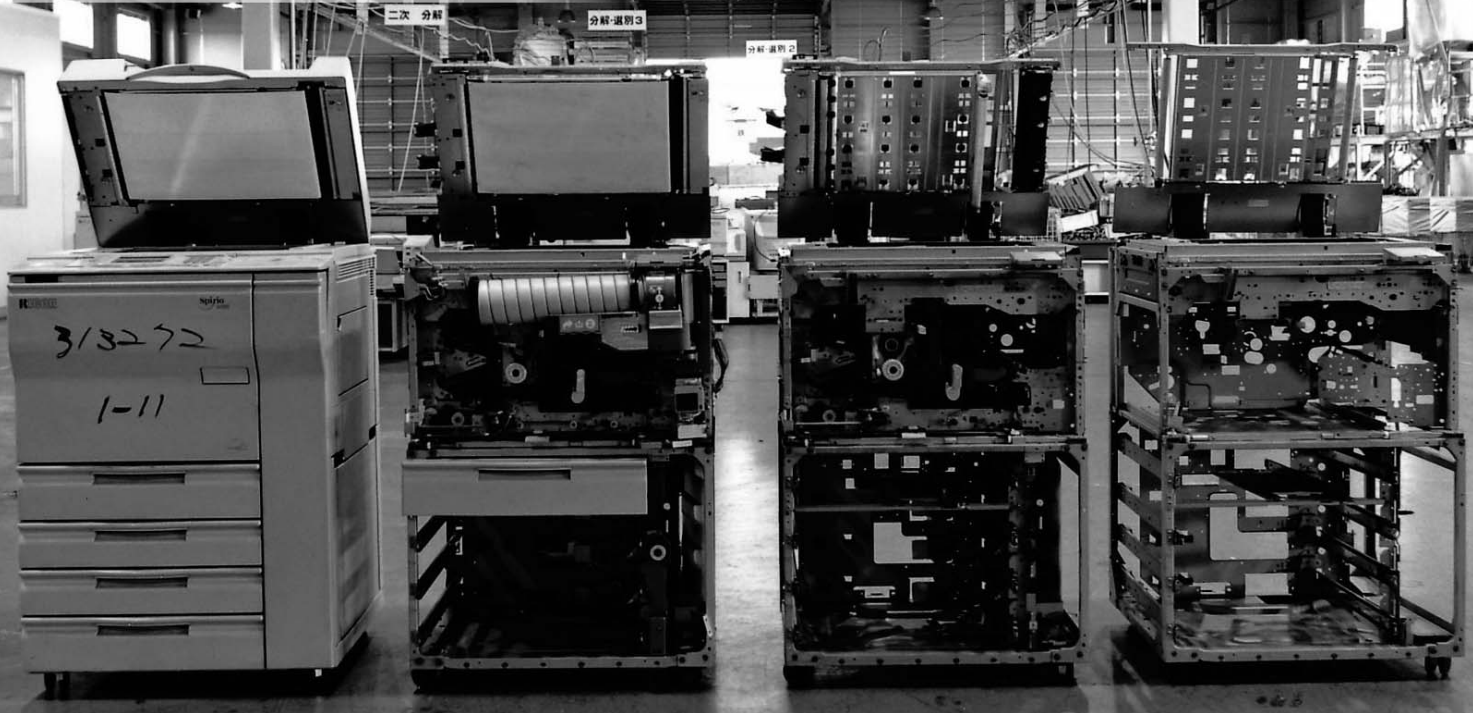
左から右へリサイクルのため分解されていくリコー複写機（リサイクルセンターで）
