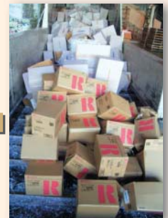
溶解ミキサーへ進む ベルトコンベア
