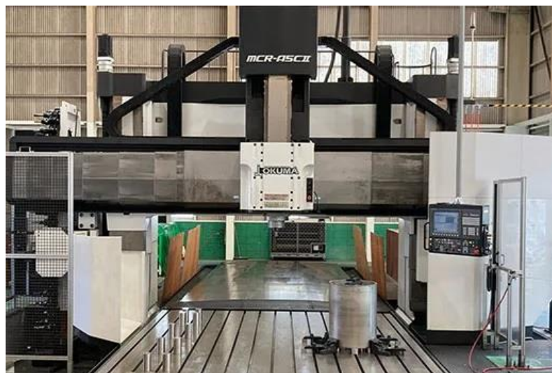
大型加工を担う5面加工門型マシニングセンタ
