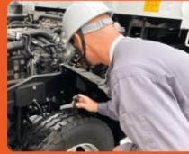
③ タイヤの状態・漏の確認
