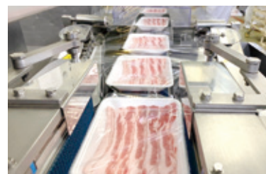
ガス置換包装のライン
