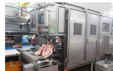
豚肩甲骨・上腕骨除骨ロボット 「ワンドスミニ マークⅡ」
