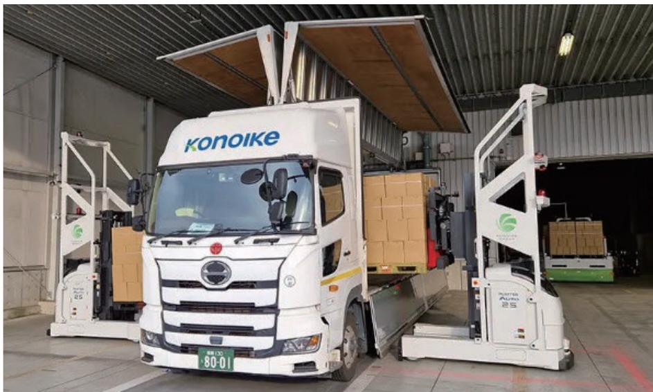
レーザー誘導式無人フォークリフト「PLATTER AUTO(プラッター オート)」をベースにした、トラックへの荷積み自動化システムを構築しました。
