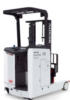
バッテリーフォークリフト「PLATTER」 (リチウムイオンバッテリー搭載仕様車)
