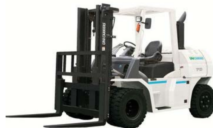
ユニキャリア社製8t積ディーゼルエンジン式フォークリフト
