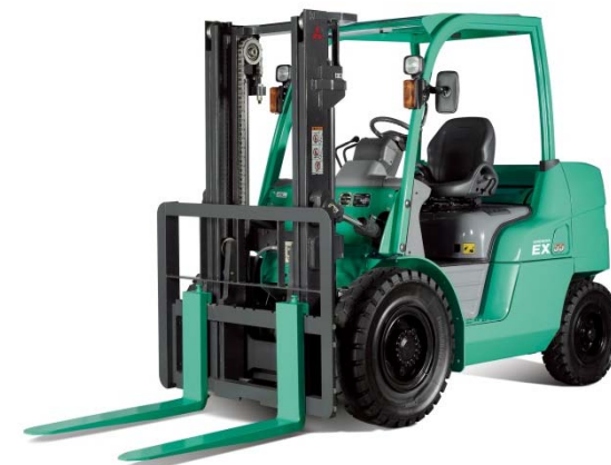
日本市場向け最終4次排気ガス規制対応 ディーゼル式エンジンフォークリフト 「GRENDiA EX」(3.5t-5.5t)
