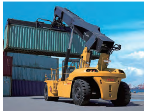
リーチスタッカー
