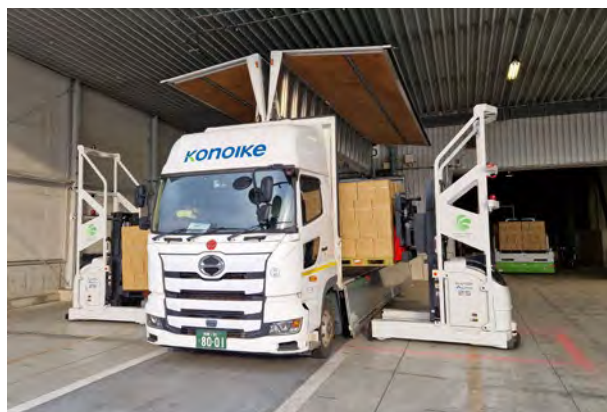
「PLATTER AUTO（プラッターオート）」によるトラックへの荷積み自動化
