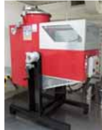
太陽誘電（フィリピン）の有機溶剤再生装置
