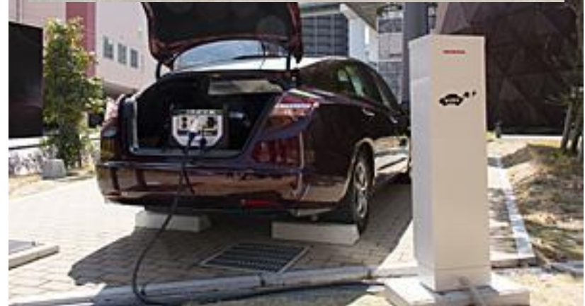
FCX Clarity 北九州実証実験用 外部出力インバータ
