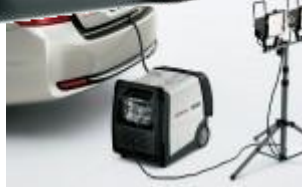
Accord P-HEV用外部出力インバータ
