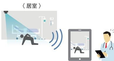
骨格認識技術と3次元カメラを用いて転倒を検知
