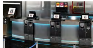
大きさ・厚み・材質・形状の異なる60ヶ国の通貨に対応するセルフ型レジつり銭機
