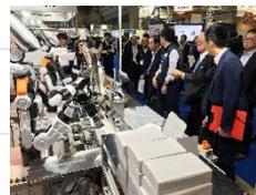
双腕スカラロボット「duAro」1台とヒト型双腕ロボット「NEXTAGE」2台を使ったお菓子の箱詰め自働ラインによる最新ソリューション事例を紹介
