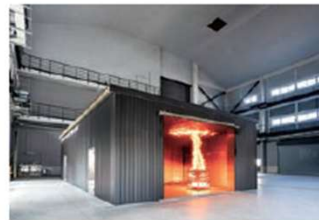
●模擬マンション [実火災環境(高温、濃煙)の再現と検証]
