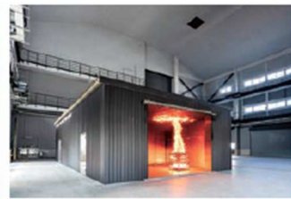
●模擬マンション [実火災環境(高温、濃煙)の再現と検証]
