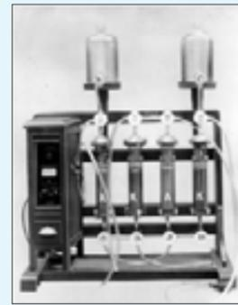
無熱蒸溜水製造装置
