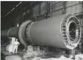
産業用大型乾燥機 (スチームチューブドライヤ)
