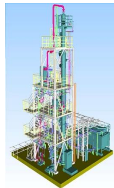
アンモニア処理装置
