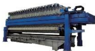
汚泥脱水機 (浄水場)
