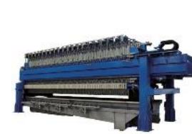
污泥脱水機 (浄水)
