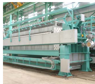
フィルタープレス（脱水機）
