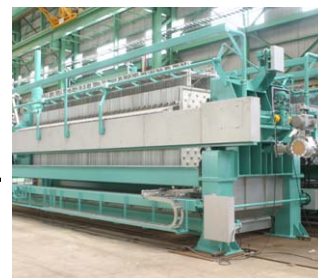
フィルタープレス（脱水機）
