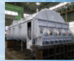
⑩脱水汚泥を減容化する汚泥乾燥機
