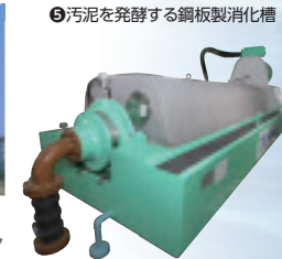
⑦汚泥を脱水する遠心脱水機
