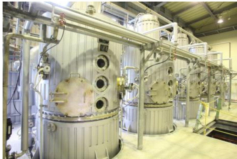
製糖工場における濃縮設備写真
