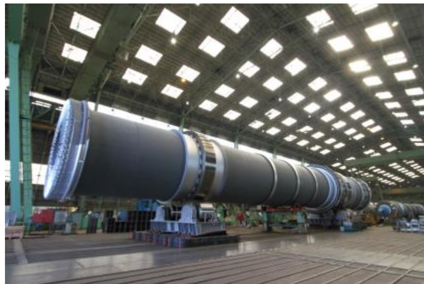
石炭調湿用大型乾燥機(スチームチューブドライヤ)
