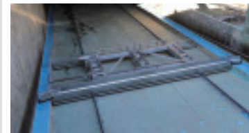
3 施工期間を短縮化、掻寄能力を向上させつつコンパクト化した新型水没クラリファイヤ「コンパクトフル®」
