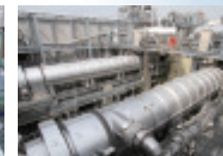
⑧汚泥を燃料化して石炭代替燃料とする「下水汚泥燃料化システム」
