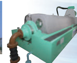
⑦汚泥を脱水する遠心脱水機
