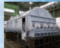
⑧ 脱水汚泥を減容化する汚泥乾燥機
