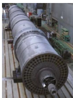
スチームチューブドライヤ (産業用大型乾燥機)
