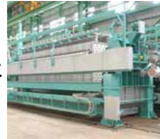
フィルタープレス(脱水機)
