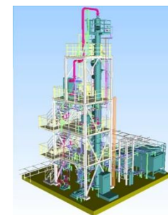
アンモニア処理装置
