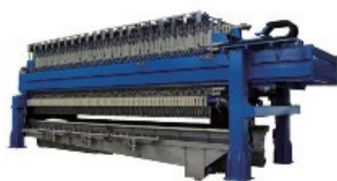
汚泥脱水機 (浄水場)
