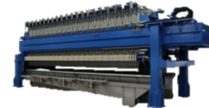
上水汚泥用フィルタープレス (脱水機)
