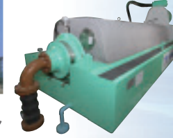
⑦汚泥を脱水する「遠心脱水機」
