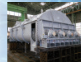
⑧脱水汚泥を減容化する「汚泥乾燥機」
