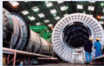
リライアンスインダストリーズ向け テレフタル酸製造用乾燥機 (インド)
