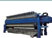
汚泥脱水機 (浄水)
