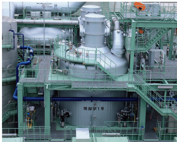
次世代型汚泥焼却システム（実績例）
