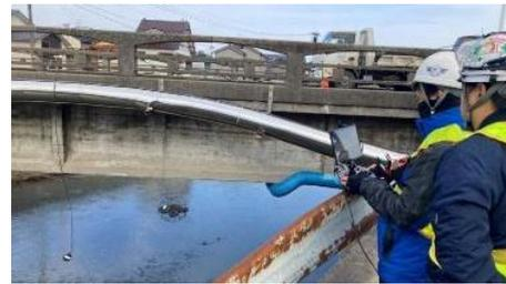
輪島市街地の橋梁について、桁下や箱桁など目視では確認できない箇所の損傷状況を球体ドローン (ELIOS 3) により確認
