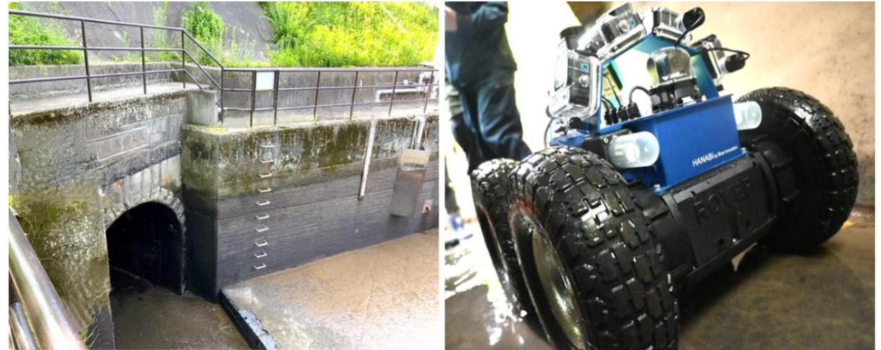
東北電力 人來田発電所の導水路（左）と点検用AGV（右）
