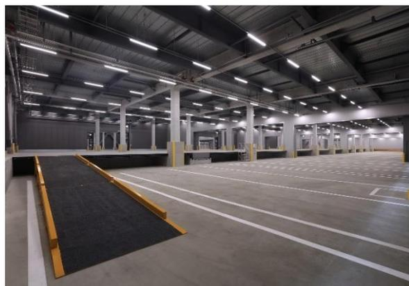
倉庫部分の基本スペックとして、外壁には金属断熱サンドイッチパネル、床荷重は 1.5 t/m<sup>2</sup>、有効高さは 1 階で 6.0m、2 階から 4 階で 5.5m 以上（一部除く）を確保しております。テナント区画として、最大で 8 テナントの入居を可能としており、最小で約 3,360 坪からの利用が可能となっております。
