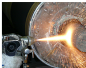
溶線式フレイム溶射（燃焼ガス）
