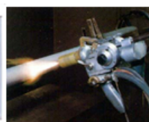
溶棒式フレイム溶射（燃焼ガス）
