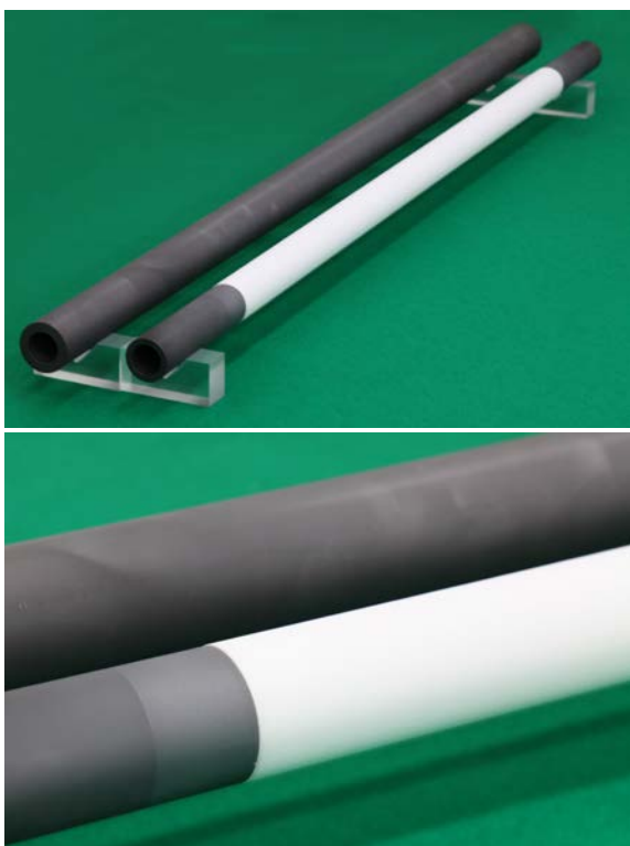
図2 開発したセラミックコーティング炭化ケイ素部材の一例(左:コーティング前、右:コーティング後)
