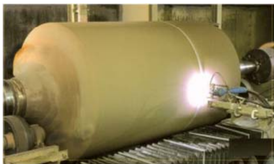
炉内ロール(ハースロール)
