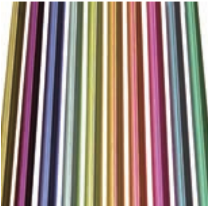
チタンの陽極酸化処理による発色例
