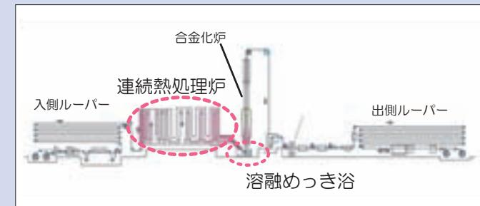
左図はCGL鋼板が製造される、連続溶融亜鉛めっきの典型的なラインを示しています。当社の表面処理、特に加工によりセラミックコーティングされたロールが、鋼板の品質と生産効率向上のために多数採用されています。
