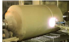
連続焼鈍炉の炉内ロール (ハースロール)
